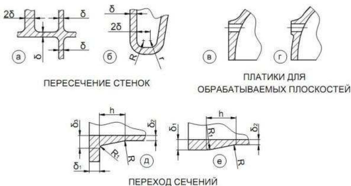
Рисунок 8 – Конструкции деталей корпуса
