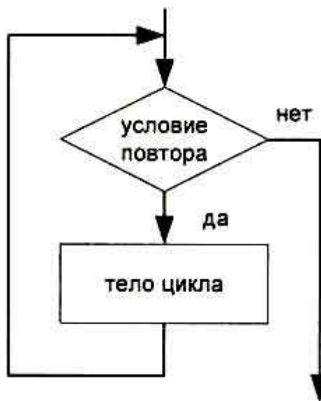
Рисунок 26 – Структура оператора while.
