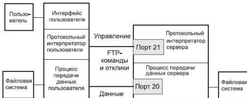
Рисунок 22 – Сетевое взаимодействие по протоколу ftp.
