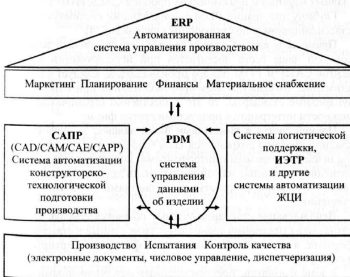
Рис 3.1 – Место PDM в общей структуре ИИС
