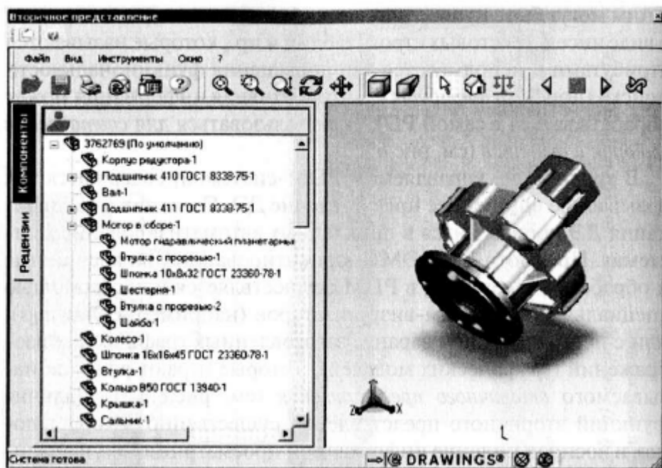
Рис. 3.5 - Использование вторичного представления при просмотре электронных моделей, содержащихся в хранилище PDM-системы
