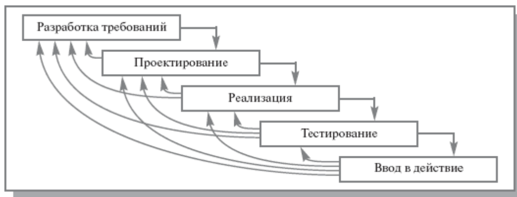
Рисунок 1.5 - Поэтапная модель с промежуточным контролем
