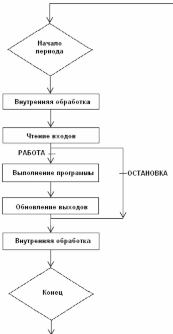
Рисунок 16 - Работа циклов при периодическом выполнении
