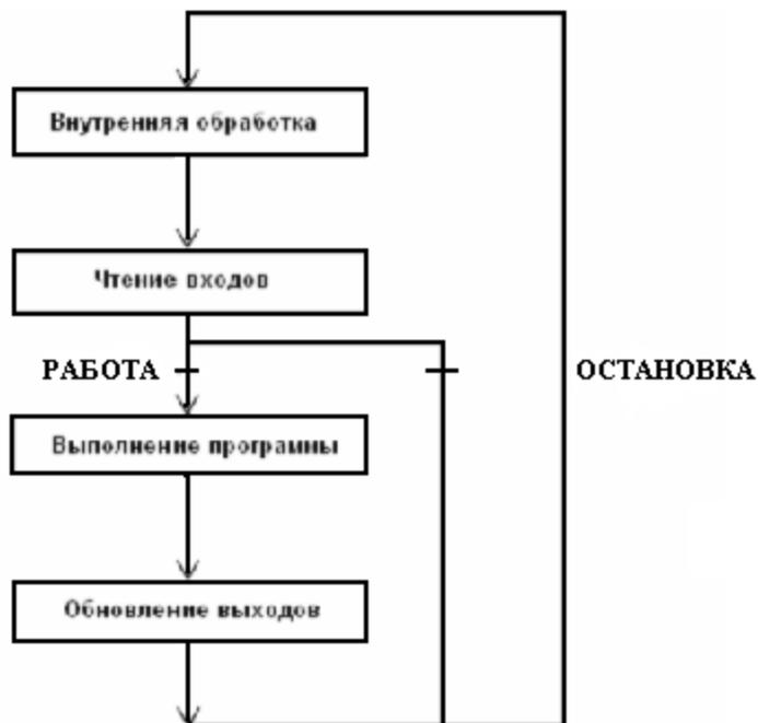
Рисунок 14 - Работа циклов при циклическом выполнении
