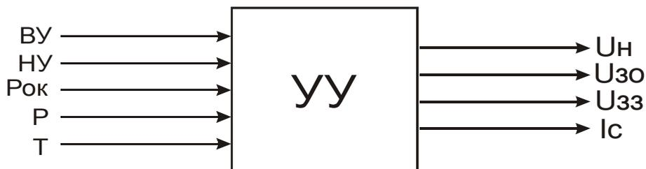
Рисунок 35 – информационные потоки управляющего устройства
