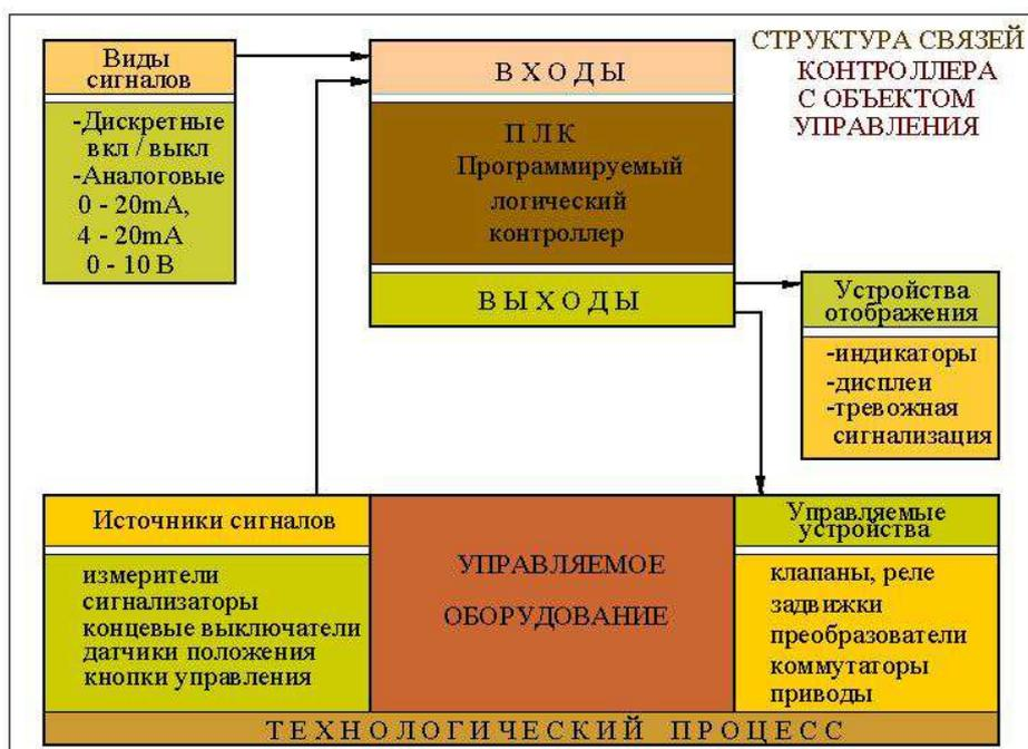
Рисунок 1 –Схема взаимодействия с объектом управления
