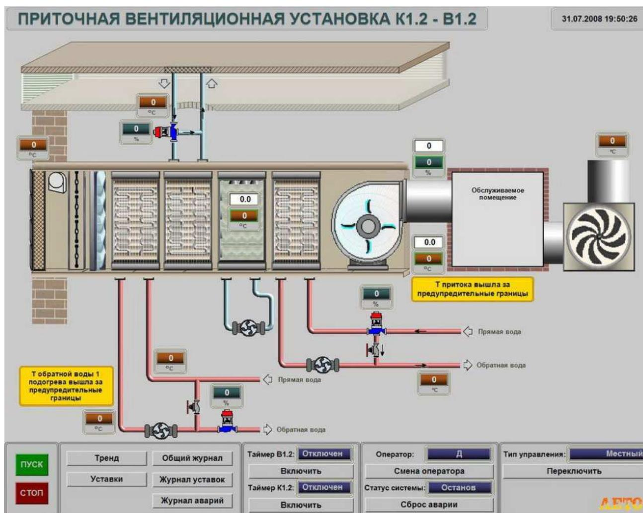
Рисунок 16 – Пример экрана SCADA системы MasterSCADA.
