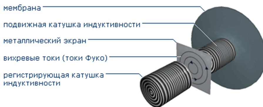
Рисунок 9 - Принципиальная схема индукционного преобразователя давления
