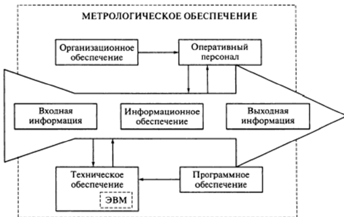
Рисунок 1 - Схема взаимодействия основных компонентов измерительных информационных систем
