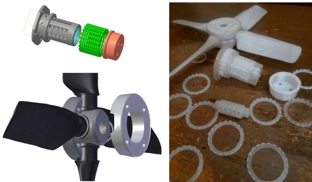
Рис. 1.6. Вращающийся распылитель жидкости для распыления химикатов с легкомоторного самолета
