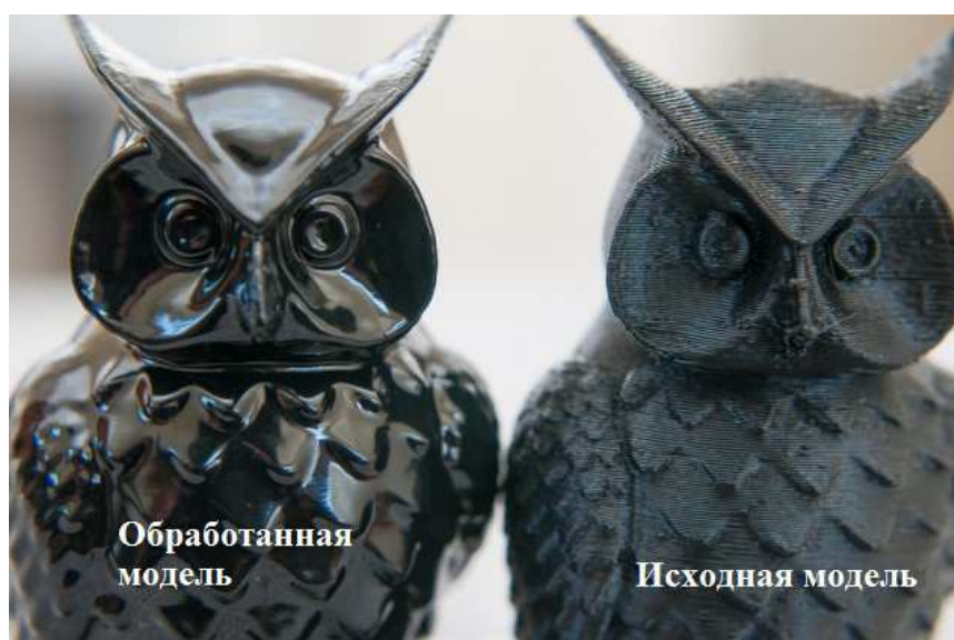
Рис. 6.2. Ацетоновая обработка ABS пластика
