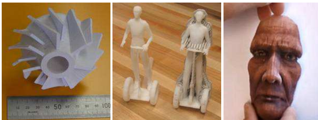
Рис. 6.18.3. 3D модели, напечатанные из бумаги
