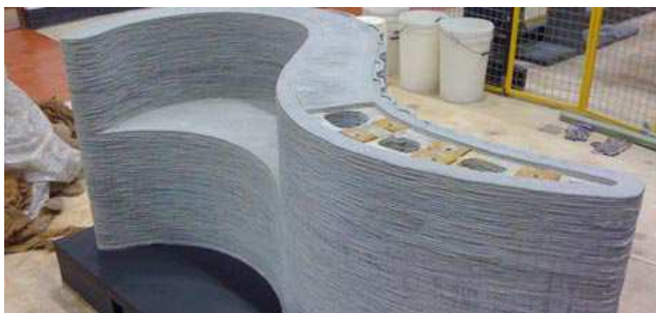
Рис. 6.18.1. Изделия, напечатанные бетоном
