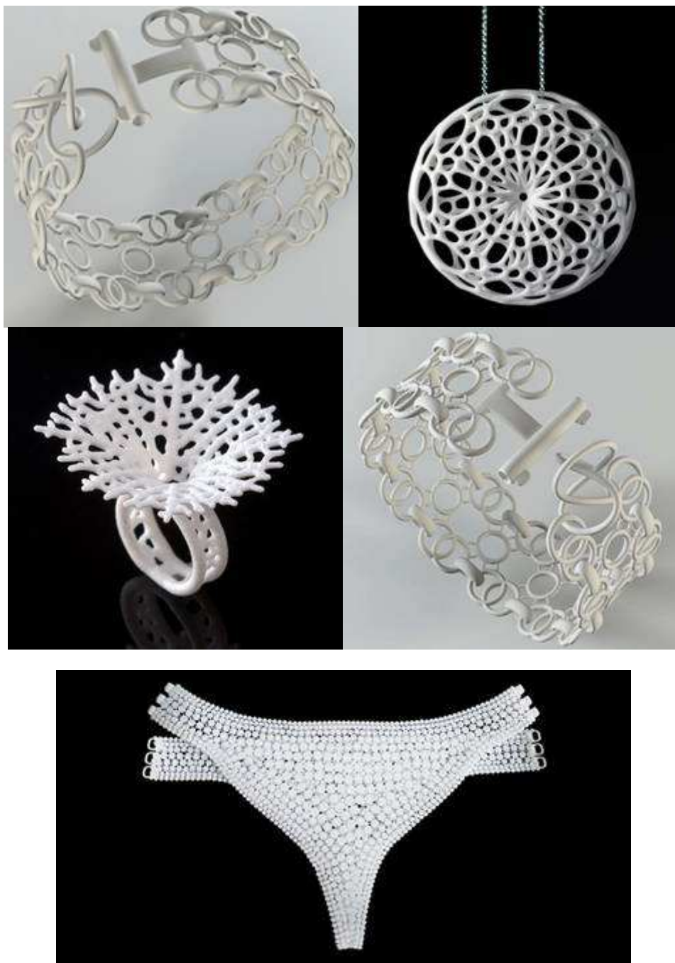
Рис. 6.3. Изделия из нейлона, напечатанные 3D принтером
