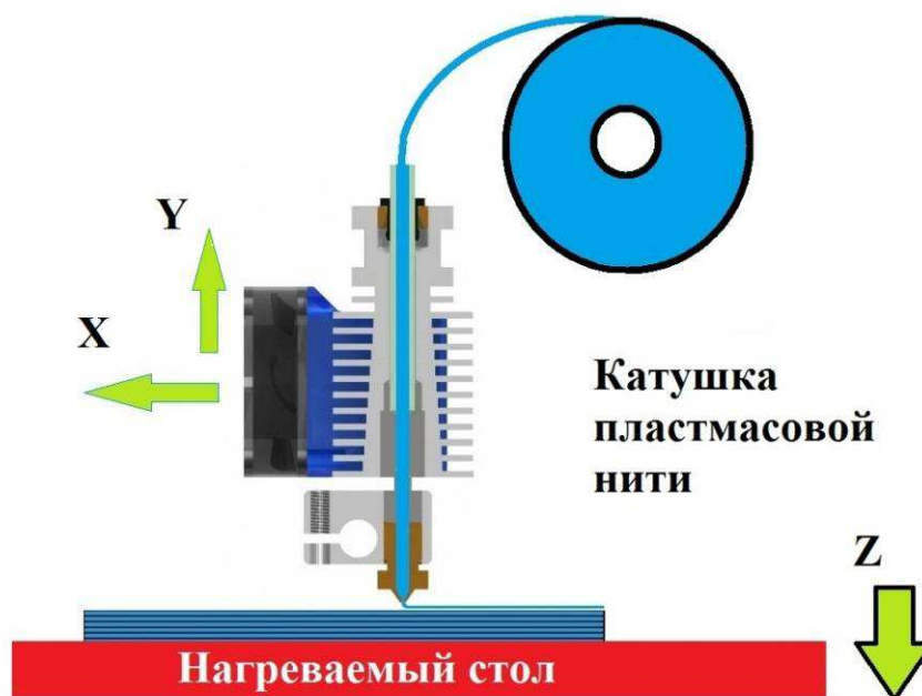
Рис. 3.5.1. Принцип FDM печати
