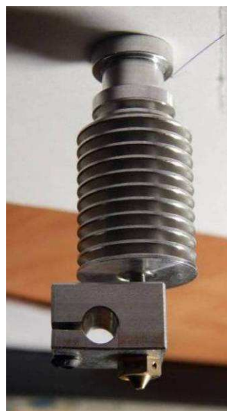
Рисунок 3.5.3. Экструзионная головка принтера FDM
