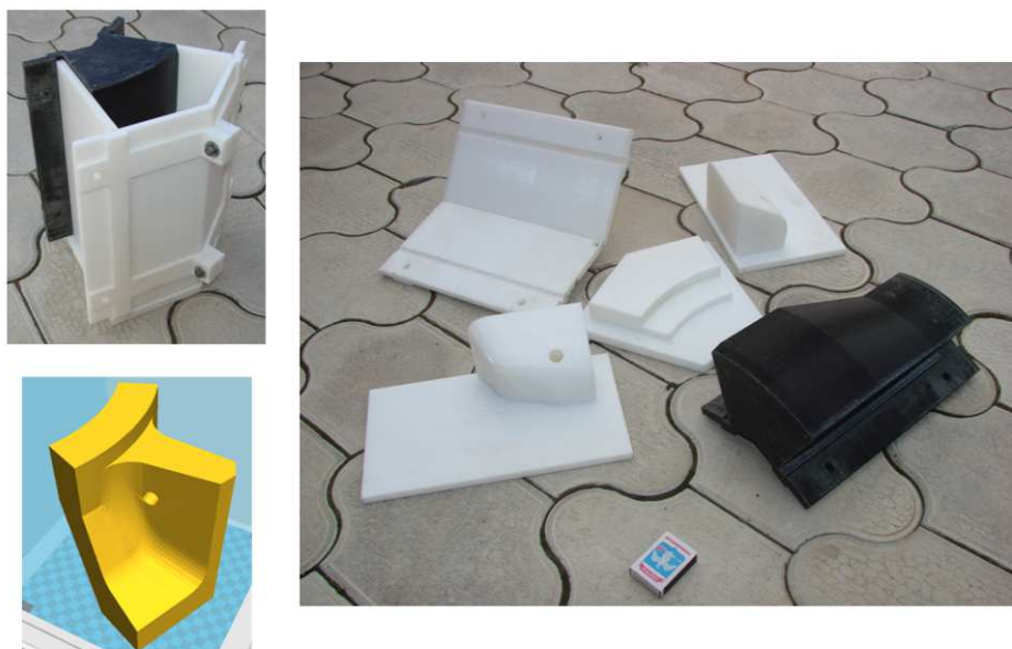
Рис. 1.5. Прессформа для изготовления деталей абразивного производства
