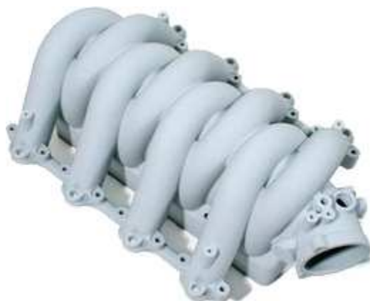
Рис. 6.18.4. 3D модель, напечатанная из гипса
