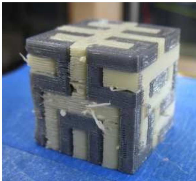
Рис. 6.5. Гильбертов куб, напечатанный ABS-пластиком (серый) и PVA (белый)
