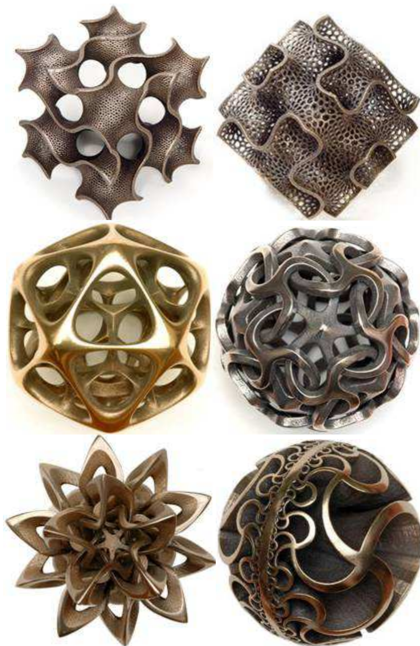
Рис. 6.18.6. Украшения из металлического порошка, напечатанные 3D принтером
