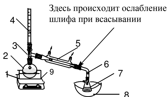
Рис. 18. Прибор для синтеза 1-бромбутана:
