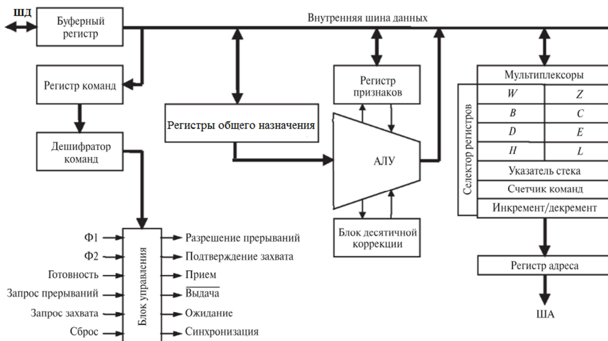
Рисунок 4 – Структурная схема микропроцессора
