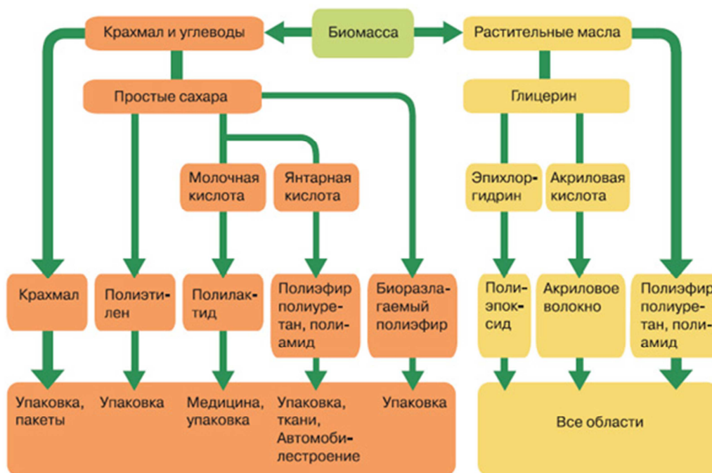
Рисунок 3.6 – Общая схема производства полимеров из растений
