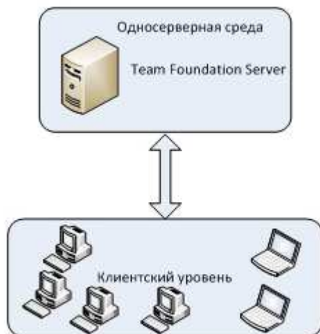
Рис. 5.2. Простейшая серверная топология TFS
