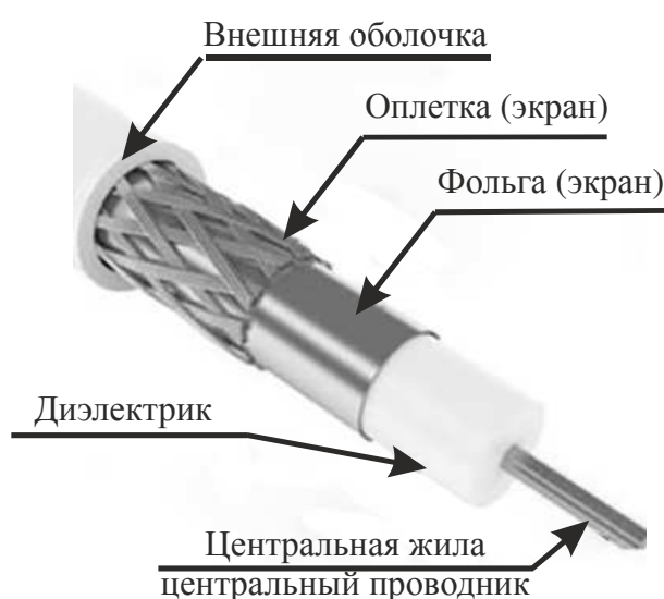
Рисунок 13 – Устройство коаксиального кабеля
