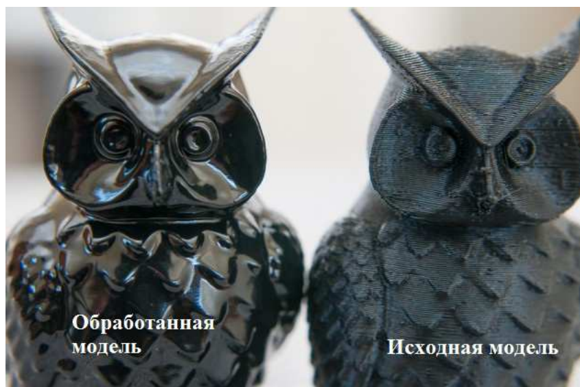
Рис. 6.2. Ацетоновая обработка ABS пластика
