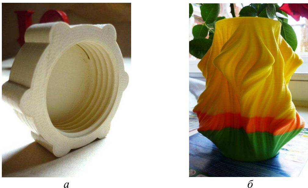
Рис. 3.2. Примеры моделей, полученных методом FDM : а – резьбовая крышка из АБС пластика; б – трехцветная ваза из PLA пластика
