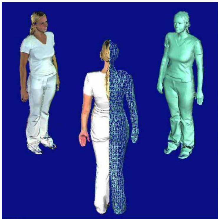
Рис. 8.1. Слева на право: исходная модель, процесс оцифровки, цифровая модель
