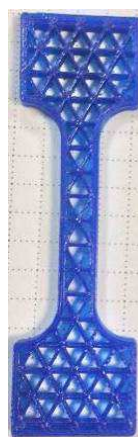
Рис. 6.8. Материал из АБС- пластика с самоармированием - полигональные и волокнистые структуры (напечатано на 3D-принтере ВПИ «3DLife»)
