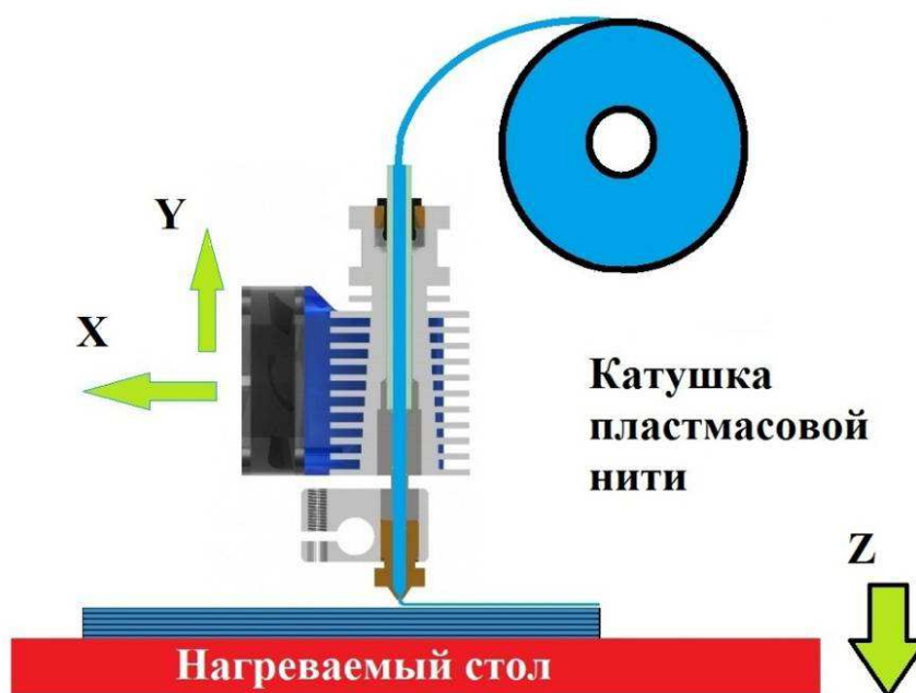
Рис. 3.1. Принцип FDM печати
