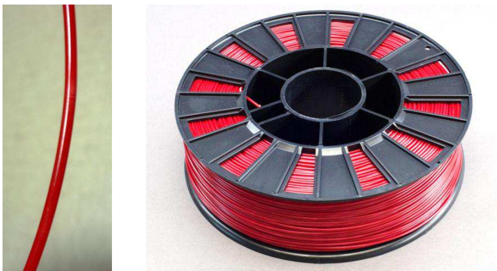
Рис. 6.1. Пруток (филамент) диаметром 1,75мм ABS пластика
