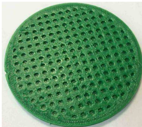
Рис. 6.8. Материал из АБС- пластика с самоармированием - полигональные и волокнистые структуры (напечатано на 3D-принтере ВПИ «3DLife»)
