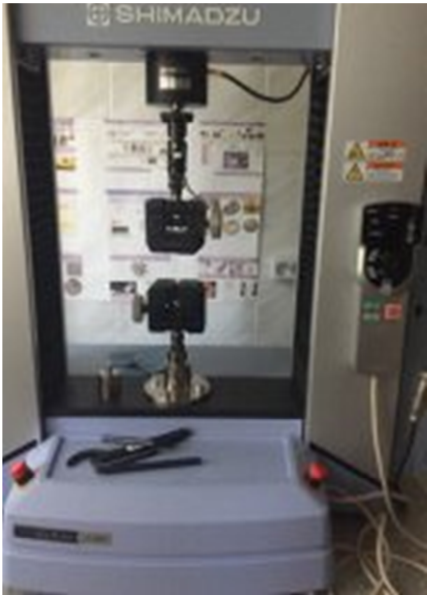
Рис. 6.2. Разрывная машина «Shimadzu»
