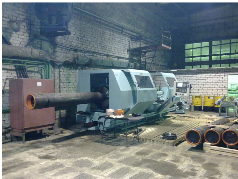
Рисунок Л 6.6 – Токарно-револьверный центр с ЧПУ модели ST-20
