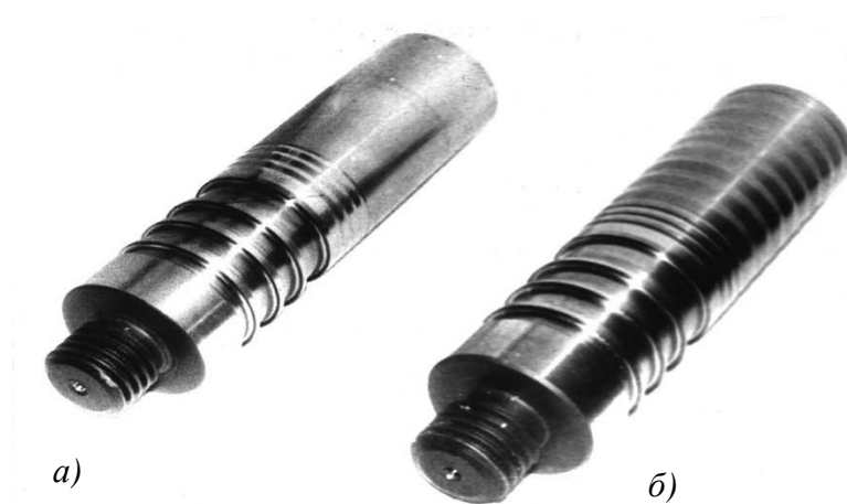
Рисунок ПА4 – Вид координатных протяжек с удлиненными задними направлениями: а – частично дорнующим и гладким задним направлением; б – протяжка с полностью дорнующим задним направлением.
