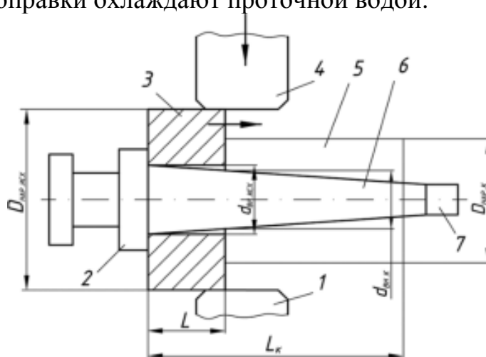
Рисунок 1.14 – Схема протяжки полой заготовки: 1 — нижний вырезной боек; 2 — бурт оправки; 3 — заготовка; 4 — плоский боек; 5 — готовая поковка; 6 — оправка; 7 — отверстие для охлаждения водой
