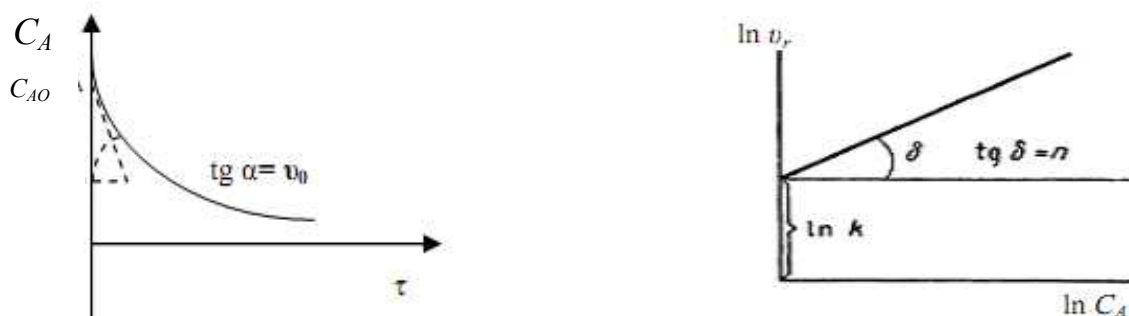
Рис. 3.4. Определение начальной скорости и порядка реакции при переменных начальных концентрациях реагента А
