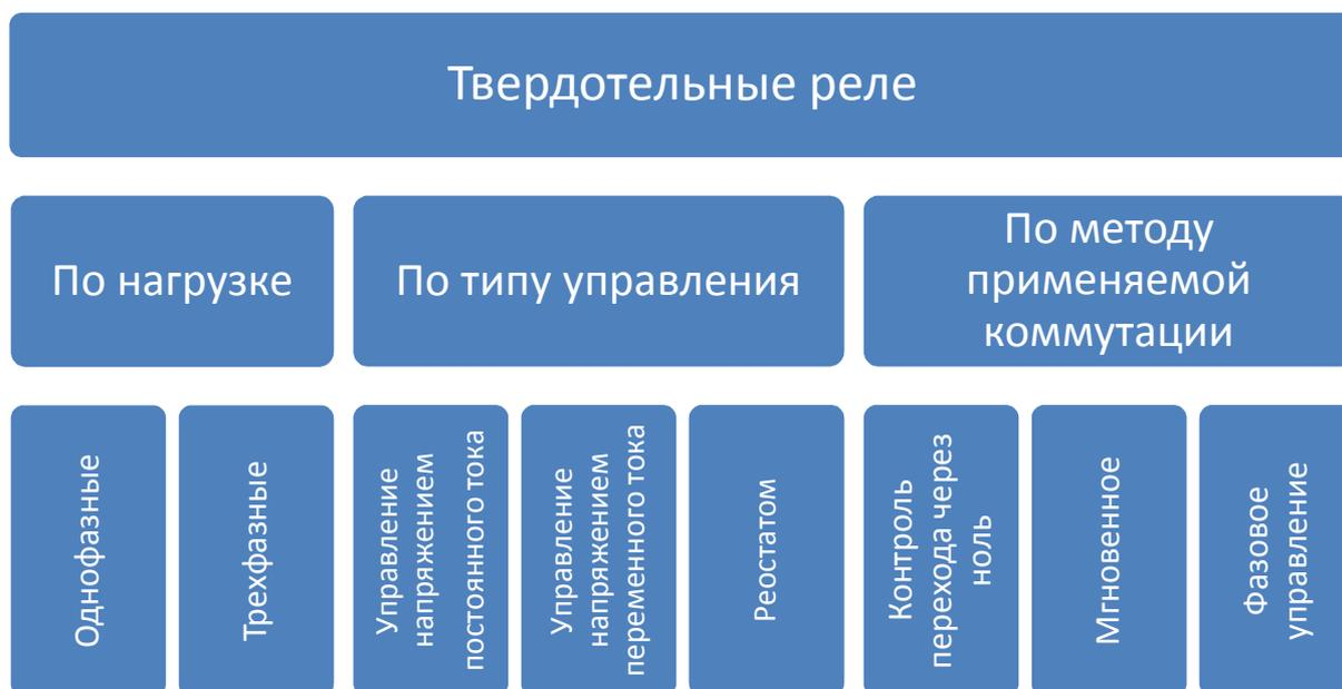
Рисунок 3.5 – Классификация твердотельных реле
