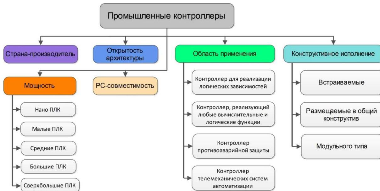
Рисунок 2.1 - Классификация промышленных контроллеров
