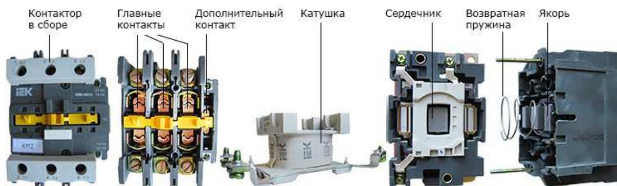
Рисунок 3.2 – Конструкция контактора
