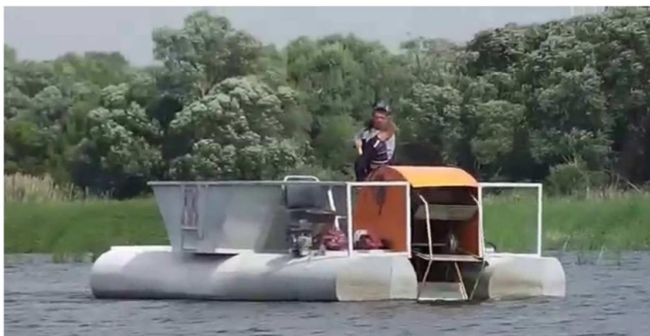
Рисунок 2.3.4. – Плавающий кормораздатчик
