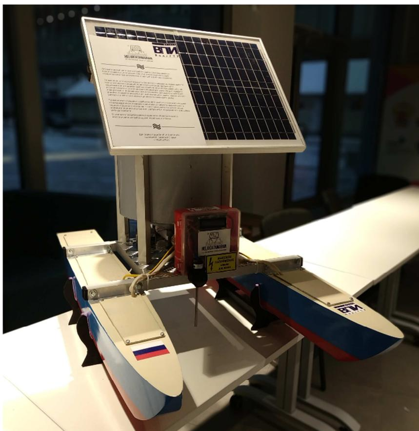
Рисунок 2.3.6. – Прототип гелиокатамарана
