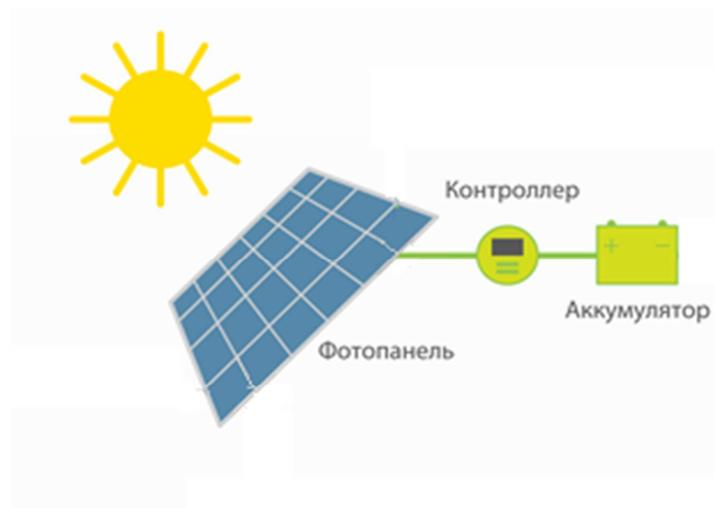
Рисунок 2.3.7. – Энергетическая установка
