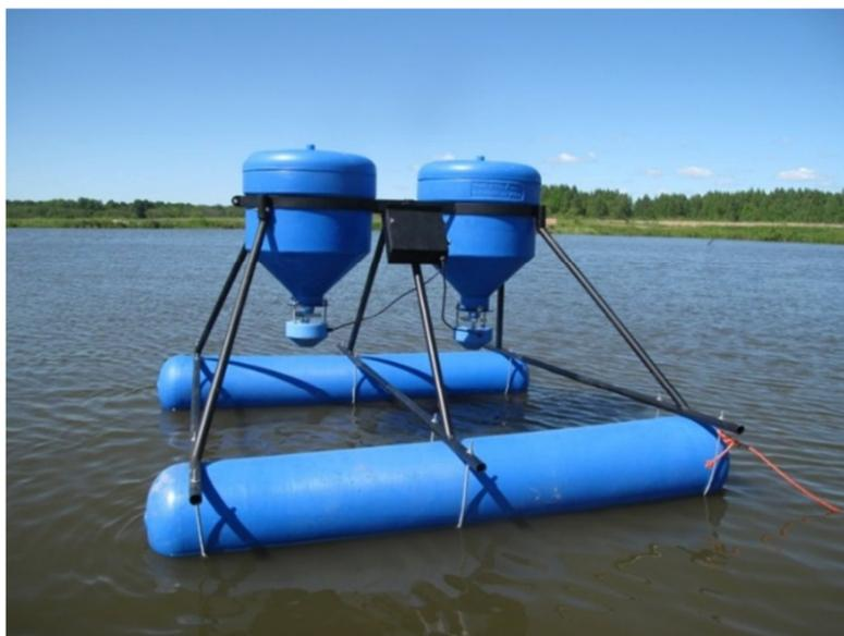
Рисунок 2.3.3. – Автоматическая кормушка понтонного типа
