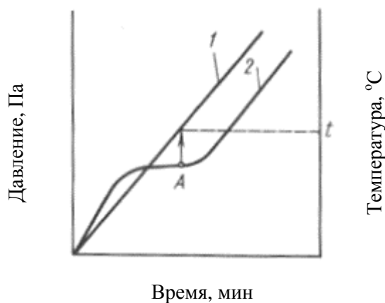
Рисунок 4.12 – График зависимости температуры (1) и давления (2) от времени
