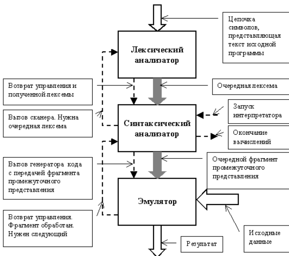
Рис. 12. Однопроходное взаимодействие блоков интерпретатора
