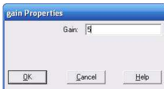
Рисунок 2.1.7. Пример задания параметра блока Gain
