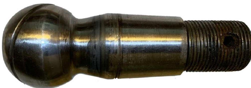
Рисунок 4.5. Шаровой палец сошки рулевого управления автобуса «Волгабас-5270GH»
