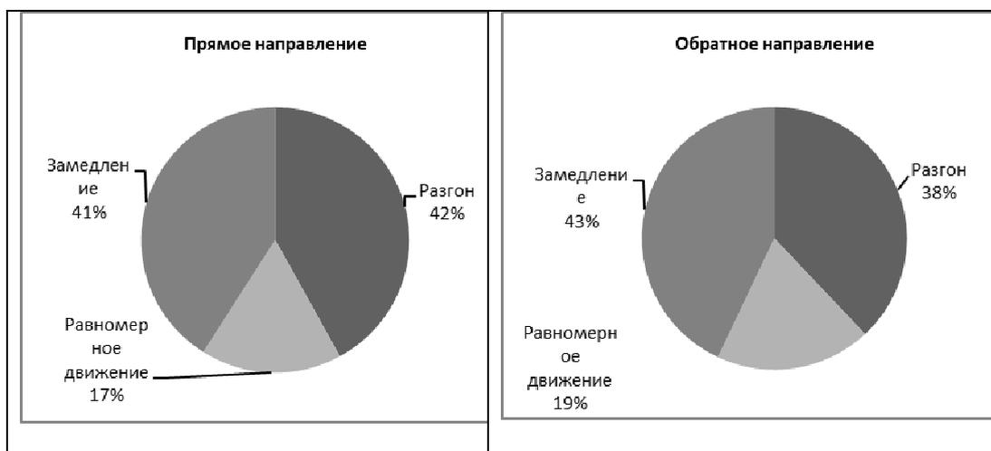
Рисунок 2.9. Режимы движения автобуса на маршруте №2У в прямом и обратном направлениях
