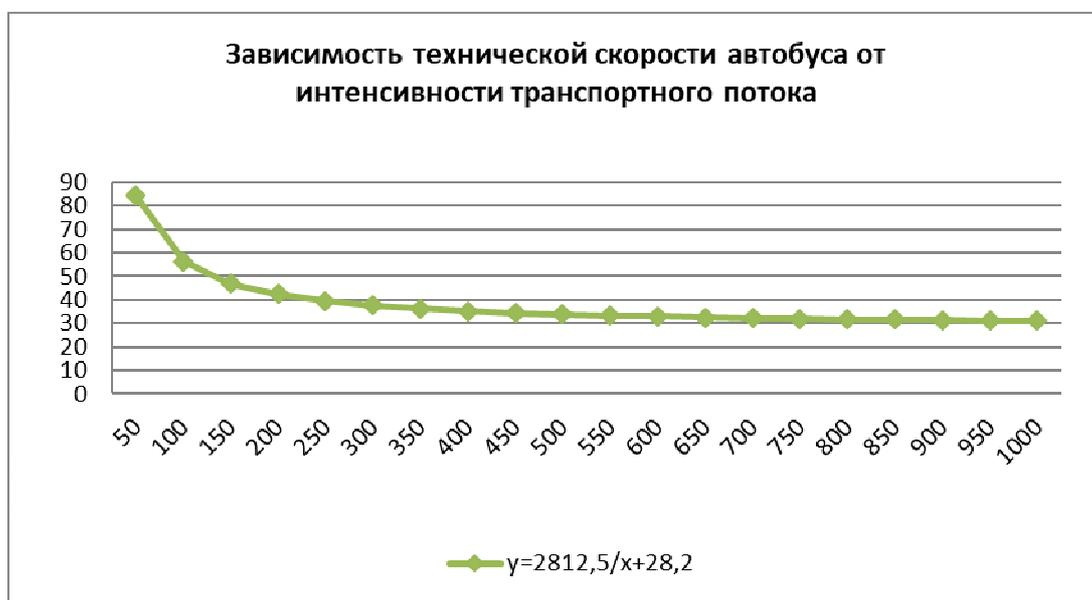
Рисунок 2.4. Зависимость технической скорости автобуса «ГАЗель» от интенсивности транспортного потока по ул. Мира в будний день
