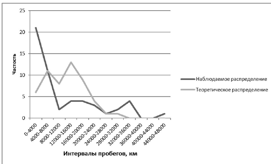
Рисунок 3.24. Распределение наблюдаемых пробегов до схода с ремонт сцепления в гарантийный период
