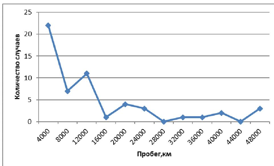
Рисунок 3.33. Распределение наблюдаемых пробегов до схода с ремонта КПП
