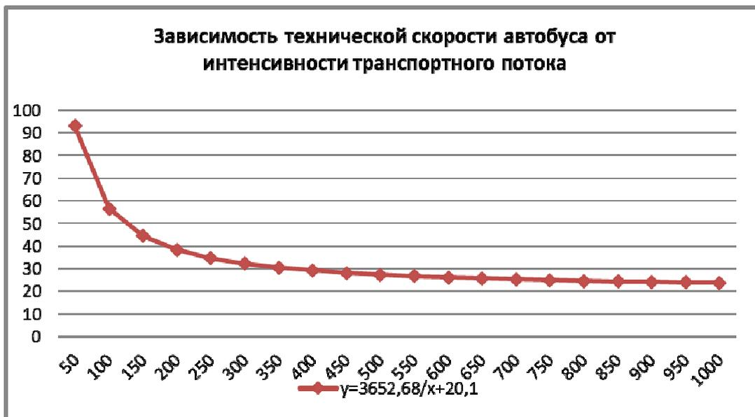
Рисунок 2.3. Зависимость технической скорости автобуса «Волжанин-6270» от интенсивности транспортного потока по ул. Мира в будний день
