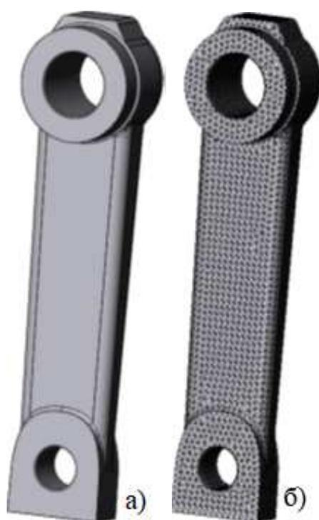
Рисунок 4.9. а) твердотельная модель рулевой сошки; б) конечно-элементная модель
