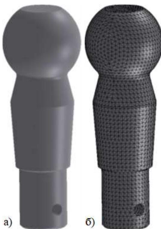
Рисунок 4.11. а) твердотельная модель; б) конечно-элементная модель
