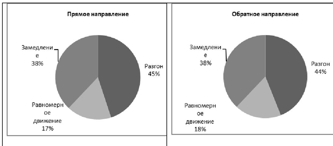
Рисунок 2.12. Режимы движения автобуса на маршруте №14 в прямом и обратном направлениях
