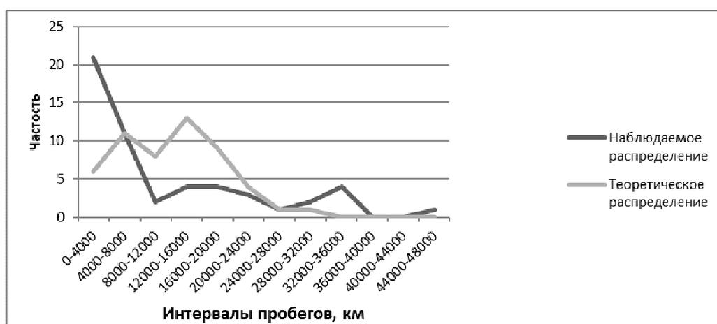
Рисунок 3.30. График распределения пробегов автобусов до сходов с неисправностью сцепления в гарантийный период
