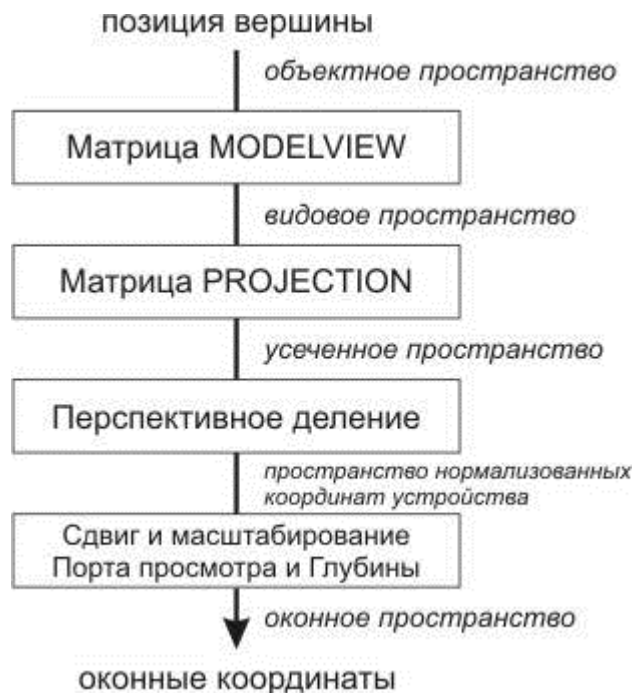
Рисунок 1. Конвейер координатных преобразований
