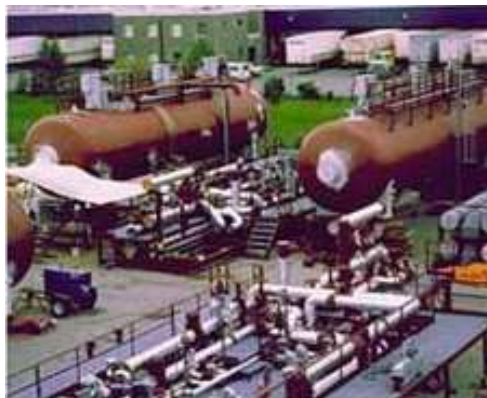
Рисунок 2 – Электрообессоливающая установка фирмы Aker Kvarner
