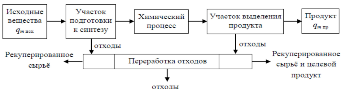
Рисунок 5 – Типичная технологическая схема химического производства
