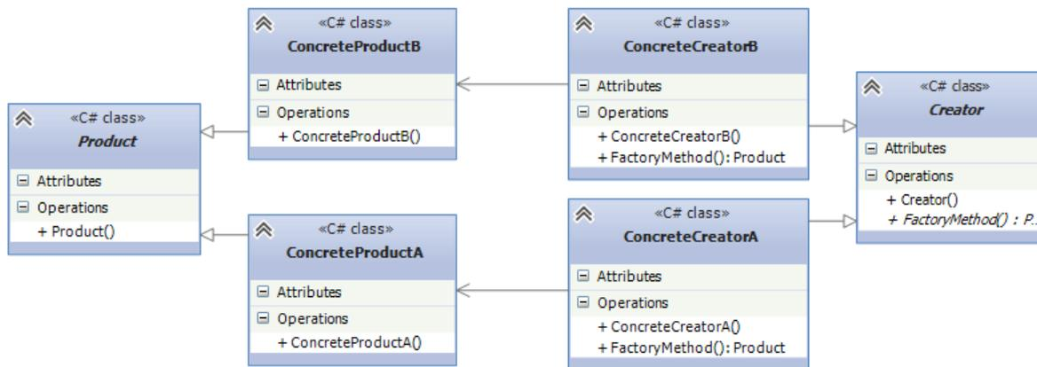
Рисунок 8. Фабричный метод (Factory Method)
