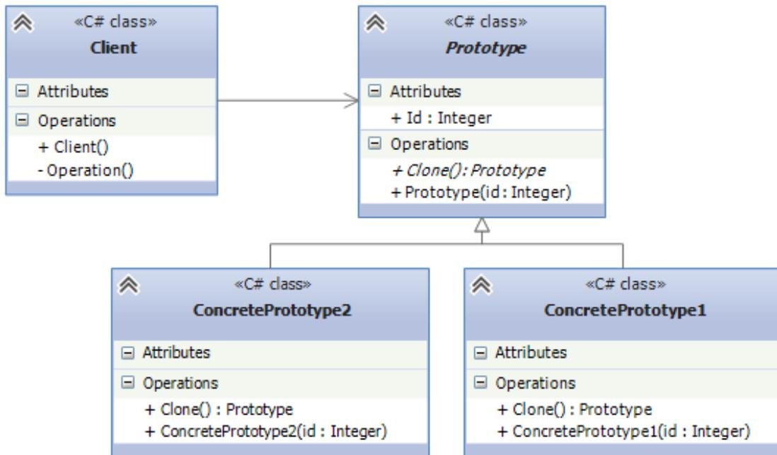
Рисунок 14. Прототип (Prototype)
