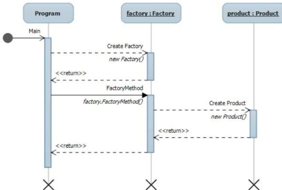
Рисунок 7. Техника использования объектов-фабрик: диаграмма последовательностей
