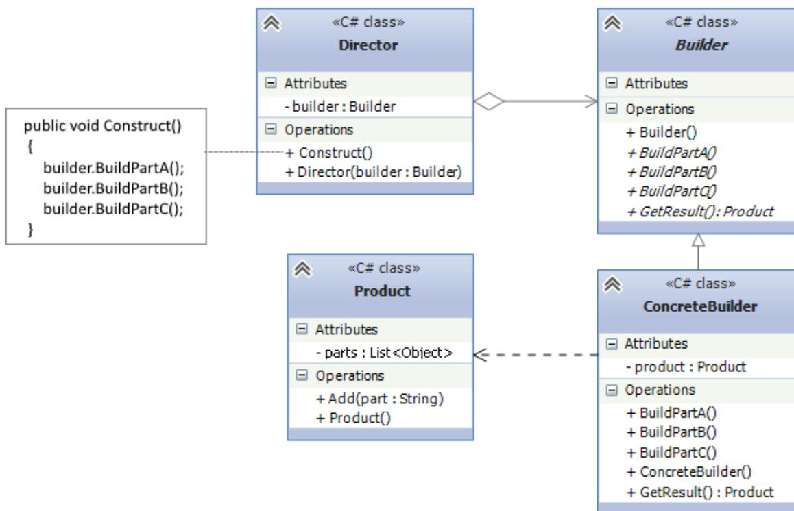
Рисунок 15. Строитель (Builder)
