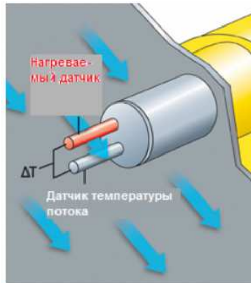
Рисунок 27 – Схема функционирования теплового расходомера
