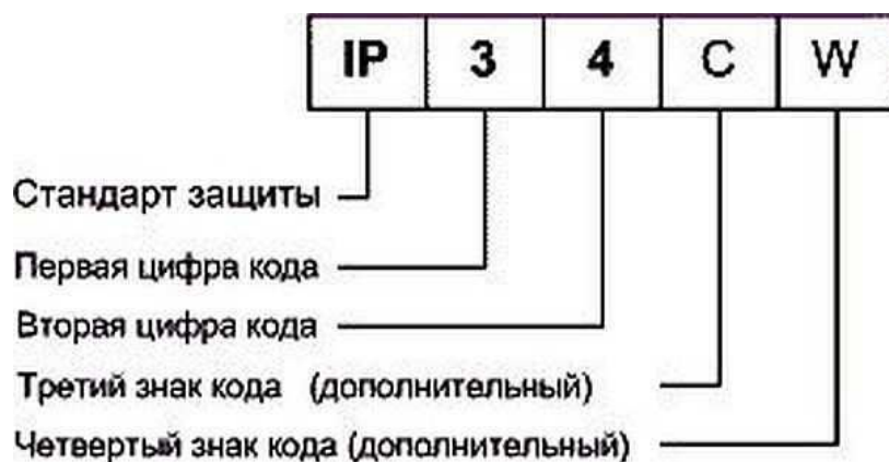
Рисунок 4 – Общая форма записи класса защиты оборудования
